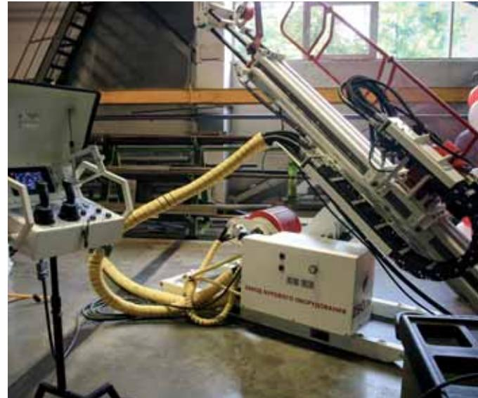
**ZBO U7E** – электрогидравлическая модификация подземной буровой установки ZBO U7, характеризующаяся тем, что основное управление станком производится с помощью гидравлических распределителей по электрическим каналам. Большинство механизмов соединены электрическим кабелем, что значительно облегчает установку и способствует быстрой настройке и переналадке. Снижены габариты и вес.
