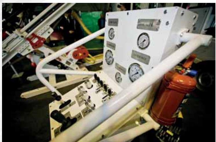
**ZBO U7** для высокоскоростного алмазного разведочного бурения на твердые полезные ископаемые. Разработана, испытана и запущена в серию в 2015 году. Оснащена системой электронного контроля.
