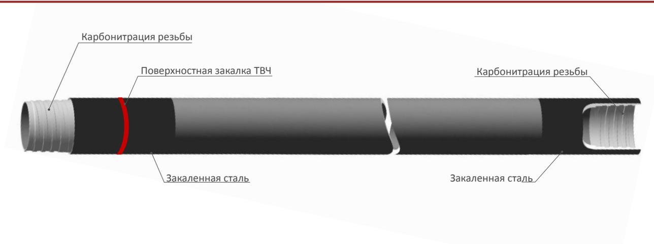
Трубы бурильные для снарядов со съемными керноприемниками предназначены для бурения геологоразведочных скважин с углом наклона 45-90° в монолитных слаботрешиноватых и трещиноватых породах VI-XI категорий по буримости, на твердые полезные ископаемые.
